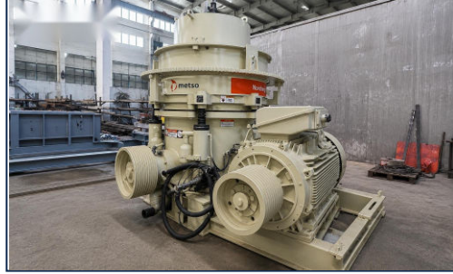
■ TAŞ KIRMA TESİSLERİNDE DRG — konkasör tahrikinde ağır hizmet motoru
